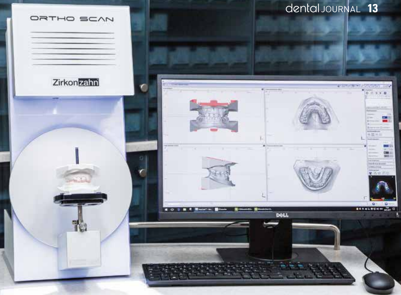
Abb. 1 Digitalisierung des Dentalmodells (hier mittels 3D-Scanner der Fa. ZirkonZahn, Gais, Südtirol/Italien)
